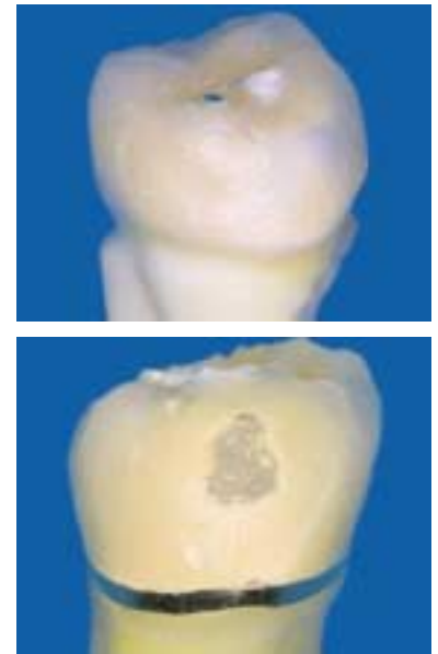
Typisches Versagen der Verblendkeramik nach der Bruchlastprüfung für eine Vollkeramik- und eine metallkeramisch Krone
